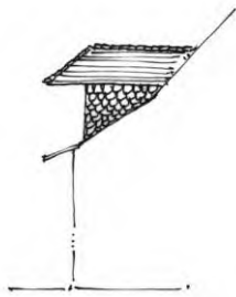
Lucarne à 3 pans, sur versant.
