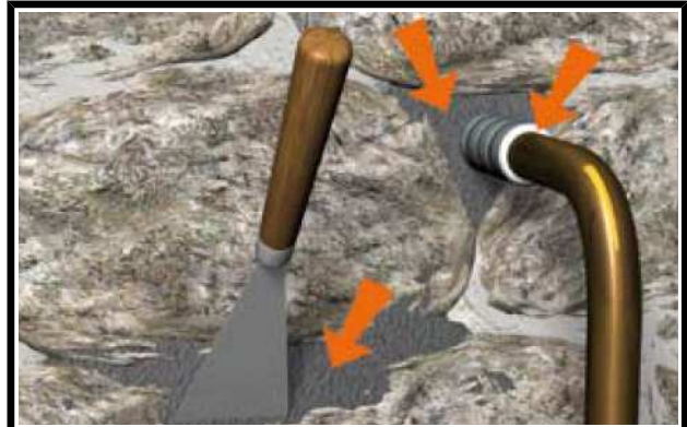
Situation après travaux de colmatage
