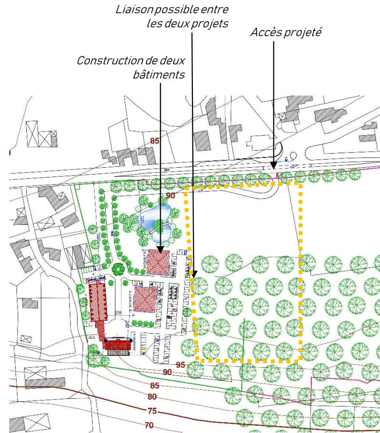
Plan du Permis de Construire actuel sur la parcelle du château avec création d'un accès sur la RD817
