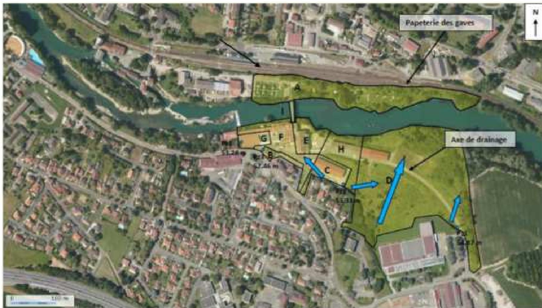
Figure 7 : localisation des piézomètres installés en octobre 2011
