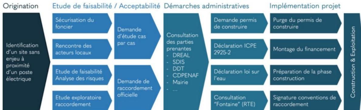
Les étapes du raccordement auprès de RTE. Les travaux de raccordement pourront être réalisés en parallèle des travaux du projet.
