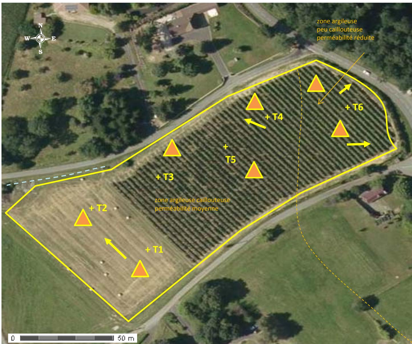
⇒ Capacité épuratoire : **SATISFAISANTE** : sol argilo-sableux - texture polyédrique - charge en cx moyenne - non hydromorphe - pas de nappe - pas d'arrivée d'eau.
