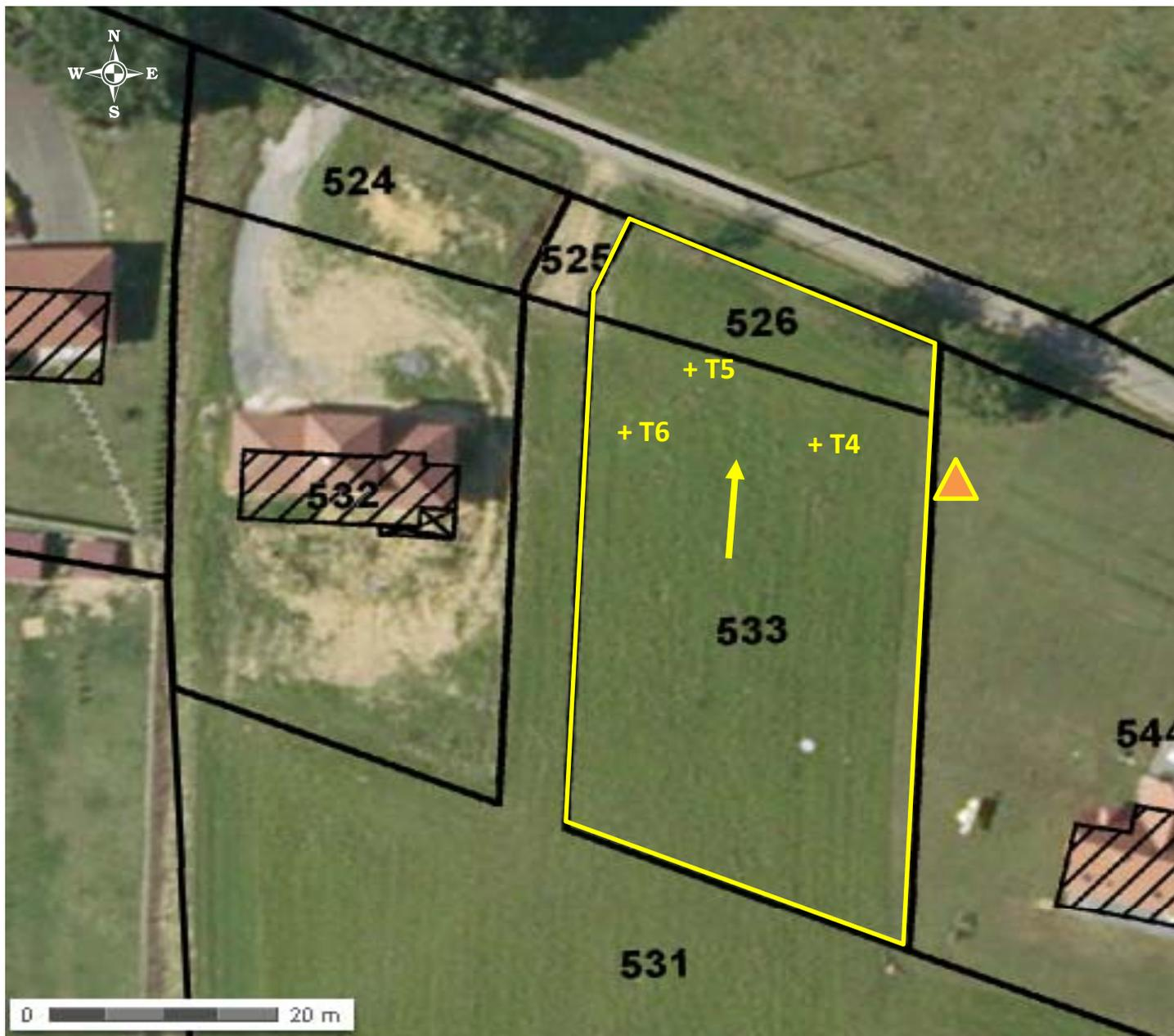
⇒ Capacité épuratoire : **FAIBLE** : sol argileux - texture polyédrique à prismatique - charge en cx faible - hydromorphe en surface - pas de nappe - arrivée d'eau sur le toit des argiles
